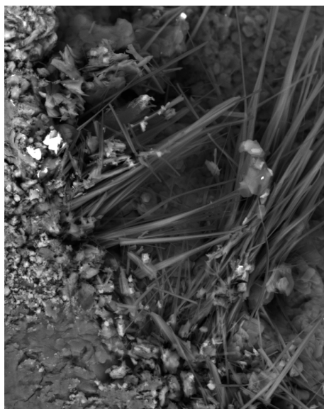
Рис. 3. Морфология кристаллов вилкоксит, месторождение Бом-Горхон (А) и галотрихита, месторождение Озерное (Б). Изображения получены на сканирующем электронном микроскопе (СЭМ)
