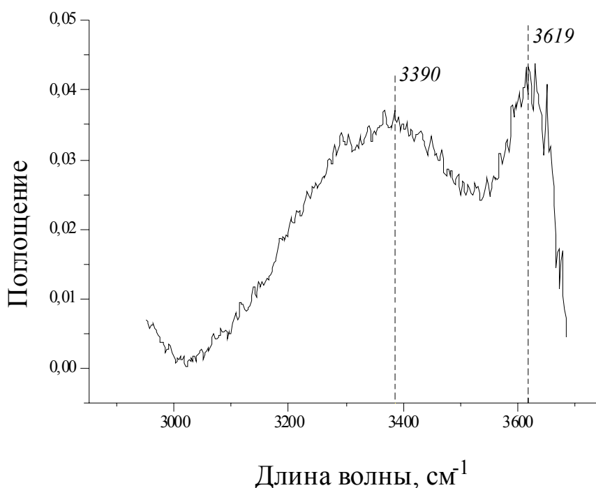
Рис. 1. Инфракрасный спектр кварца с широким спектром поглощения в области 3400\text{ см}^{-1} и узким спектром поглощения в области 3600\text{ см}^{-1} .
