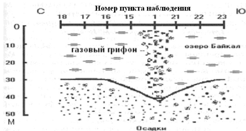
Рис. 1.24. Профиль рельефа дна через пропарину № 26 с севера на юг Fig. 1.24. Profiling of bottom relief through ice hole № 26 from north to south
